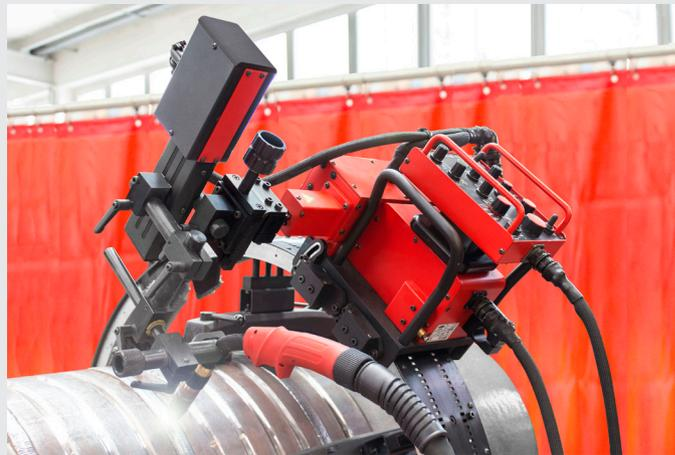
/ Oscilação linear com controle de corrente do arco durante a soldagem orbital.
