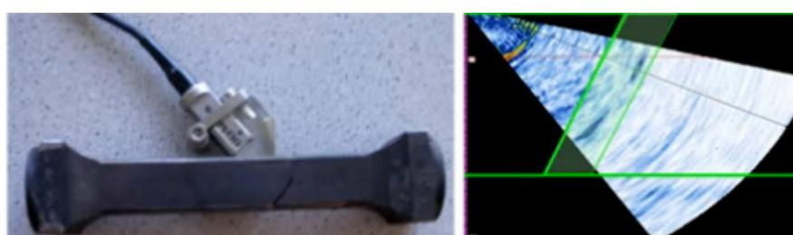
Foto mostrando a detecção de uma trinca e a imagem Phased Array correspondente
