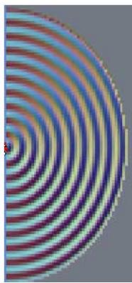
Propagação de ondas devido à perturbação em um ponto.
