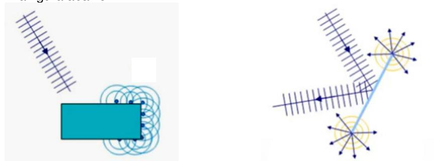
Objeto vibra ao impactar uma onda ultrassônica
