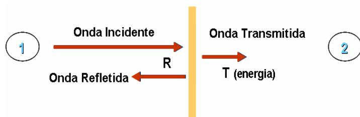
Em geral podemos calcular as frações de energia sônica que é transmitida e refletida pela interface entre dois materiais diferentes usando as seguintes fórmulas:
