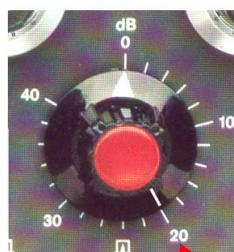
Observe a altura do eco na tela do aparelho em 100%, ajustado no controle de ganho em 20 dB.
