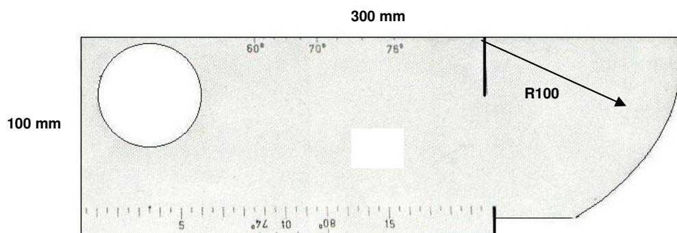
Bloco de Calibração Tipo 1 - Norma EN-12223
