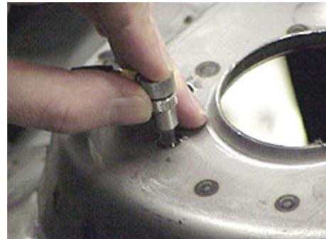
Equipamento portatil para inspeção de soldas a ponto por ultrassom
