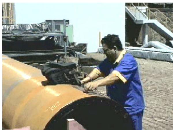
Inspeção por ultrassom da chapa de um tubo
