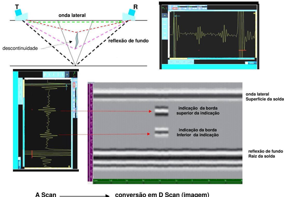
No exemplo anterior, observem que a visualização da descontinuidade é feita pela simples observação da imagem na tela. O comprimento ( $L$ ) da descontinuidade, profundidade, altura e sua posição na junta soldada, em relação ao ponto zero, é lida diretamente na escala na tela do aparelho (eixo X). A imagem obtida na tela é possível grava-la ou imprimi-la para registro e análise posterior.
