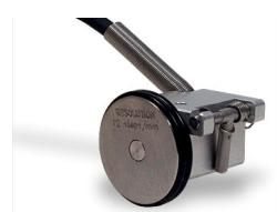
Encoder Olympus modelo Mini-Wheel usado para posicionamento e dimensionamento de indicações no eixo de varredura. Isto sincroniza a aquisição dos dados com o movimento do transdutor.
