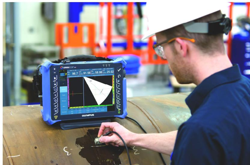
Inspeção típica de uma solda usando a técnica Phased-Array.
