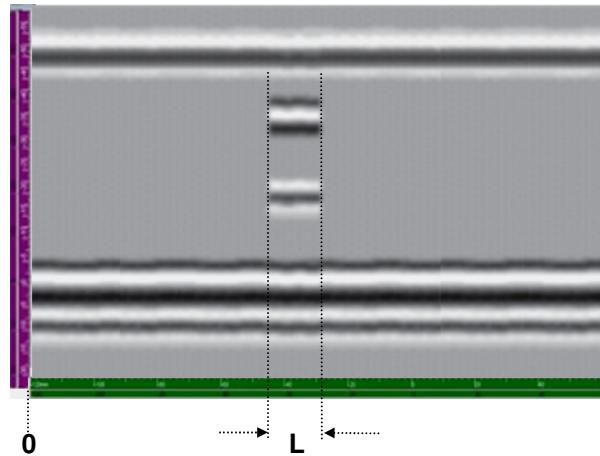
Caso exista uma descontinuidade na superfície da solda, por exemplo uma trinca superficial, a onda lateral será bloqueada pela descontinuidade e o sinal na tela não existirá, tornando fácil sua interpretação. Da mesma forma, caso exista uma falta de penetração na raiz da junta em "V" mostrada no exemplo abaixo, a reflexão de fundo será bloqueada pela descontinuidade e o sinal na tela não existirá, e assim será fácil sua identificação na tela.
