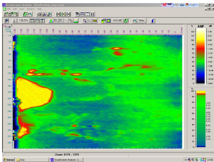
Tela do aparelho GE modelo USIP-40 em C-Scan de uma peça com revestimento. As áreas amarelas mostram falta de aderência do revestimento no metal base.
