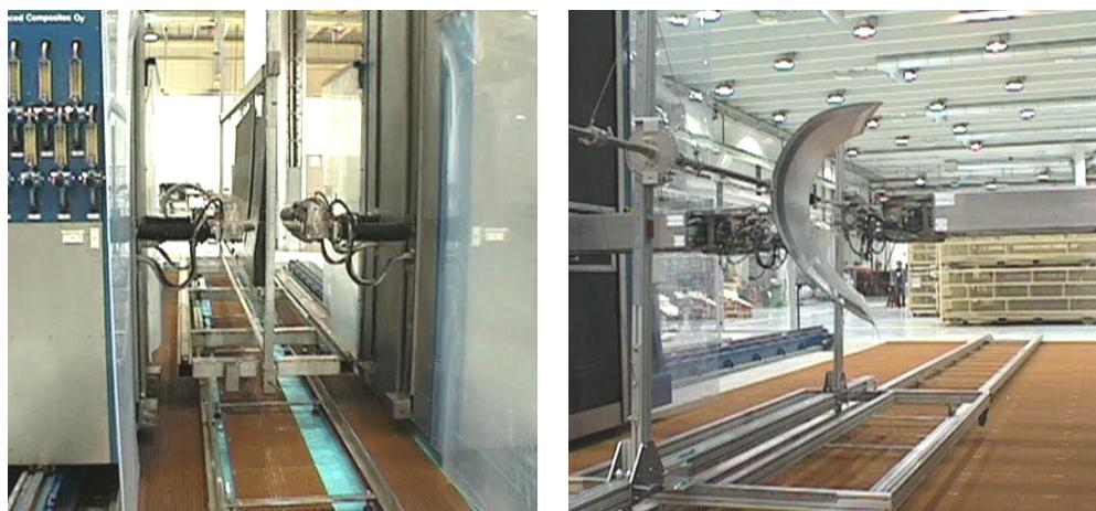
Sistemas automáticos robotizados de inspeção por transparência usando transdutores com acoplamento por jato de água (water-jet)
