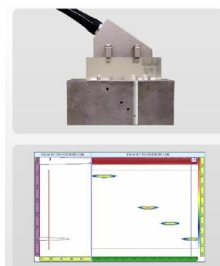
A representação B - Scan também pode ser realizada com o transdutor Phased Array. No exemplo da figura ao lado, o transdutor não é movimentado, a sequencia de ecos é realizada eletronicamente com os vários cristais do transdutor.
