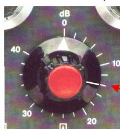
Reduzindo o eco para 50% da altura da tela, ou seja metade, será necessário retirar 6 dB no controle de ganho e portanto o novo ajuste será em 14 dB
