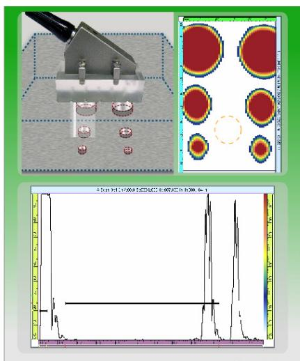
Varredura C-Scan com método Phased Array. Mais rápido em razão dos inúmeros cristais no transdutor.
