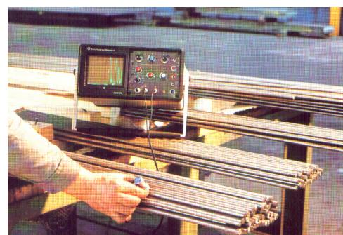
Inspeção de barras pela técnica pulso-eco por contato direto, usando transdutor normal de 12 mm de diâmetro.
