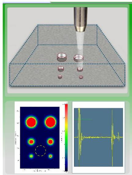
C-Scan - neste tipo de apresentação a tela do aparelho mostra a peça no sentido "planta" ou seja a vista de cima da peça. A varredura do transdutor, geralmente mecanizada, mostra as indicações na tela do aparelho visualizadas por cima, no entanto o software permite que seja obtido mais informações sobre cada uma das indicações, tal como profundidade, amplitude, etc....
