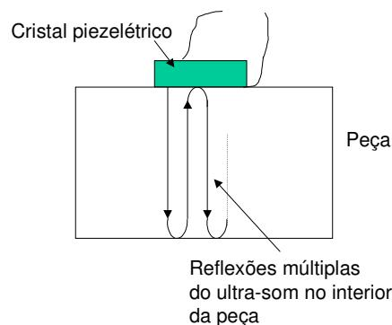
Para cada incidência do ultrassom na superfície oposta de acoplamento do cristal, um sinal será transmitido ao aparelho e um eco correspondente a este sinal será visualizado na tela. Portanto será possível observar vários ecos de reflexão de fundo correspondente à mesma espessura.
