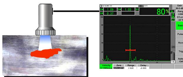
Em seguida, o transdutor deverá ser deslocado para a direita e esquerda, horizontalmente de forma a visualizar a queda do eco em 6 dB ou seja metade da amplitude, ou seja 40%. Nestes pontos deverão ser marcados na superfície da peça.
