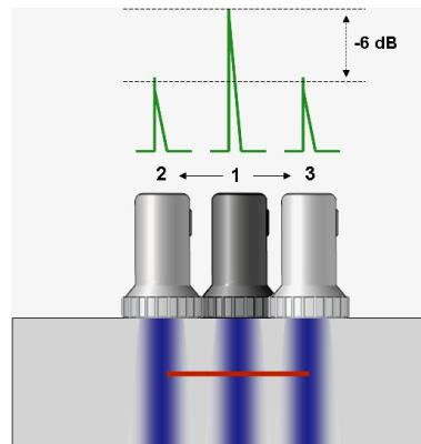
Delimitação da extensão de uma dupla laminação em uma chapa, usando a técnica da queda do eco em 6 dB , com transdutor normal. O deslocamento do transdutor para a posição (2) e posição (3) , faz com que o eco de reflexão caia para metade em relação à posição (1). Esta instrução está descrita também na pág.77.
