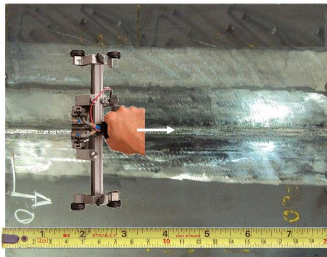
Exemplo de escaneamento TOFD manual da junta soldada usando um dispositivo mecânico dotado de rodinhas. No dispositivo é fixado os transdutores e o encoder.
