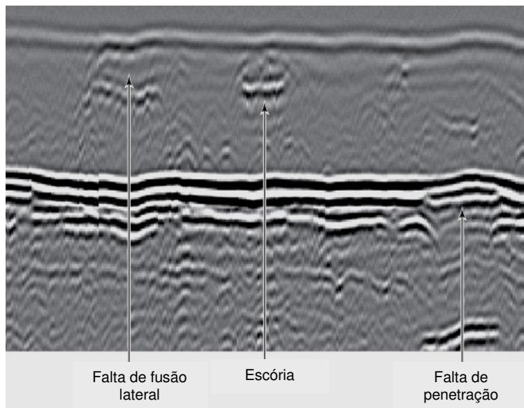
Indicações típicas de descontinuidades em juntas soldadas pela técnica TOFD
