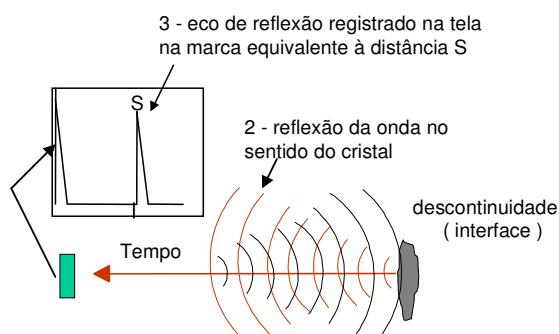
Ao incidir numa **interface** , ou seja na descontinuidade que está na distância “S” , ocorre a reflexão da onda , detectada pelo cristal.
