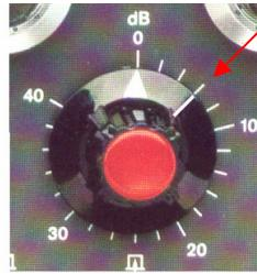
Reduzindo o eco para 20% da altura da tela, será necessário retirar 14 dB no controle de ganho e portanto novo ajuste para 6 dB.
