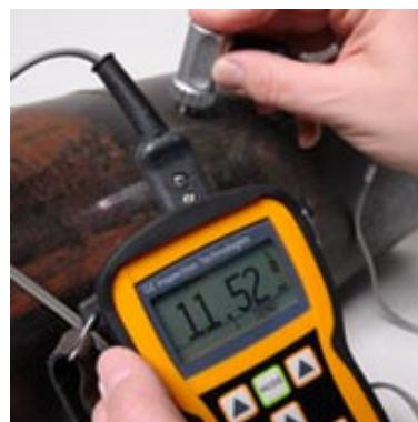
Medidor de Espessura Digital Ultrassônico GE Modelo DM4E
