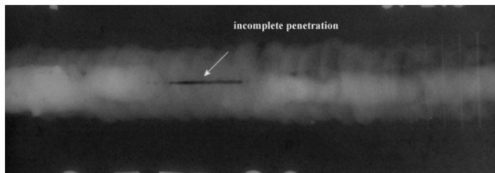
Imagen radiográfica da falta de penetração da solda abaixo.
