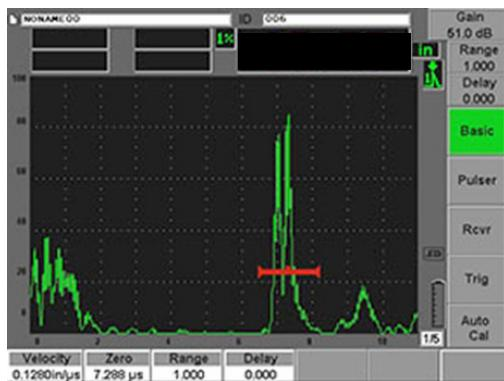
Indicação típica de ultrassom na tela do aparelho resultante da falta de penetração da solda
