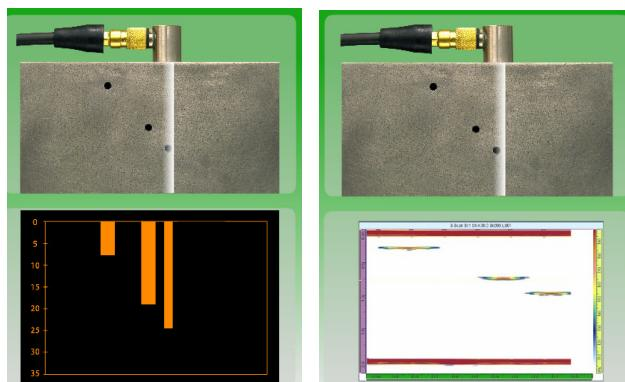
B-Scan - É muito útil para análise de corrosão em peças e tubos e chapas pois o perfil da espessura é vista diretamente na tela.
