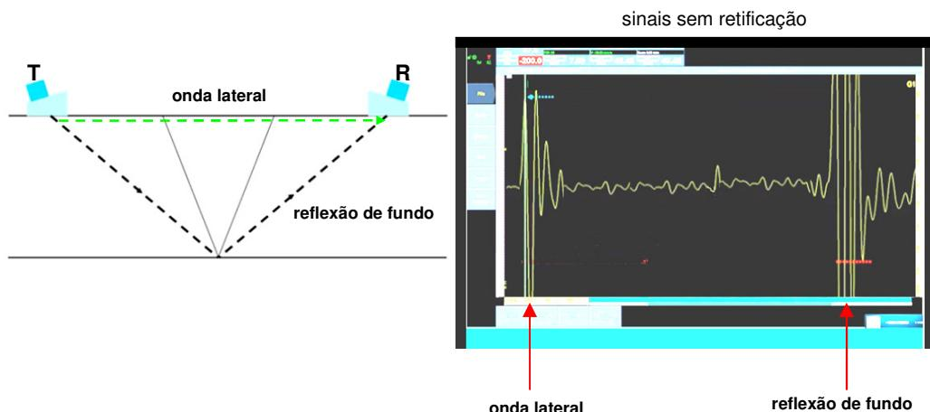
Observe que nas indicações na tela do aparelho, sem retificação, o sinal da onda lateral ocorre primeiro, pois a distância é menor que a indicação de fundo, devido à reflexão do feixe sonico na parede oposta da peça. Portanto qualquer indicação que aparecer entre o sinal da onda lateral e a reflexão de fundo, deve ser analisada pois provavelmente pode se tratar de uma descontinuidade.
