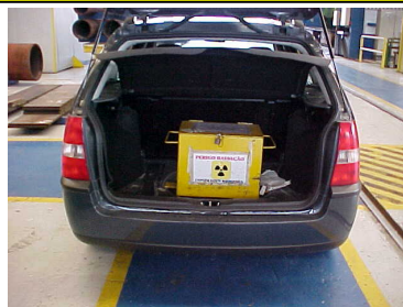
Caixa metálica que contém o irradiador Fixação da caixa metálica no veículo
