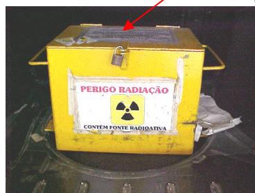
Caixa metálica que contém o irradiador Fixação da caixa metálica no veículo
