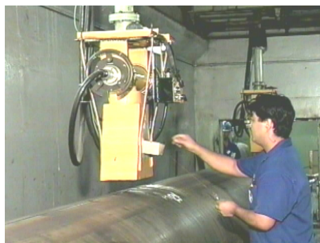
Inspeção radiográfica de soldas em tubos
