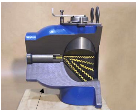
Irradiador (unidade de radiação) que contém a fonte de radiação e blindagem de proteção.
