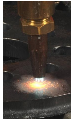
Com o oxicorte o metal precisa ser pré-aquecido aproximadamente a 1000 °C antes de começar a perfurar.
