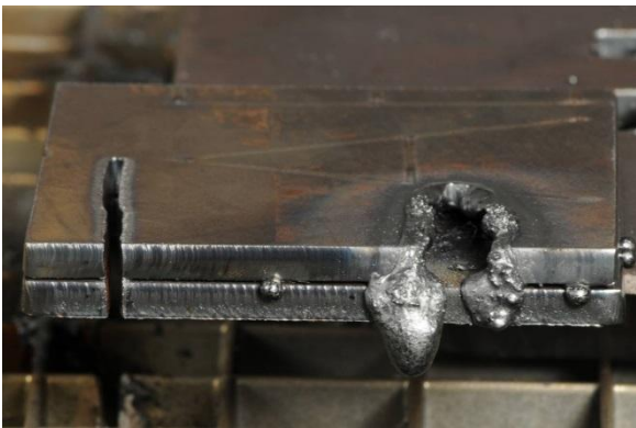
Com o plasma, é possível cortar chapas empilhadas com um corte limpo. Com o oxicorte isso é impossível.
