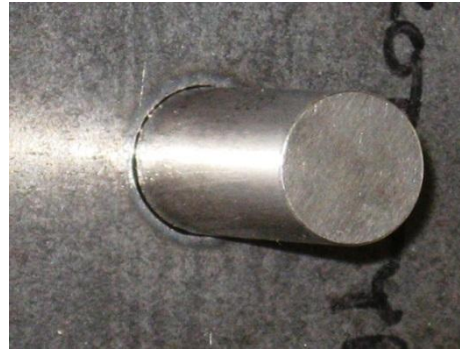
O sistema a plasma integrado produz furos sem conicidade.
