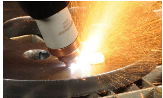
Perfurar com o plasma aumentará sua produtividade pois não é necessário pré-aquecer.
