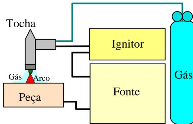
Figura 2 – Equipamento básico para a soldagem GTAW
