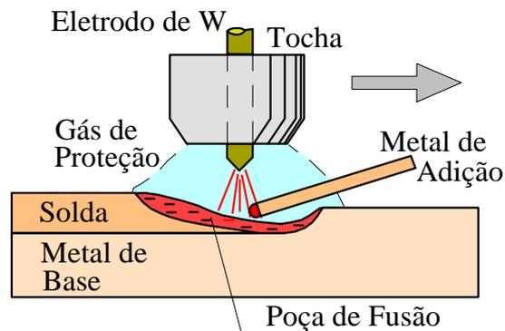
Figura 1 – Região do arco na soldagem GTAW.
