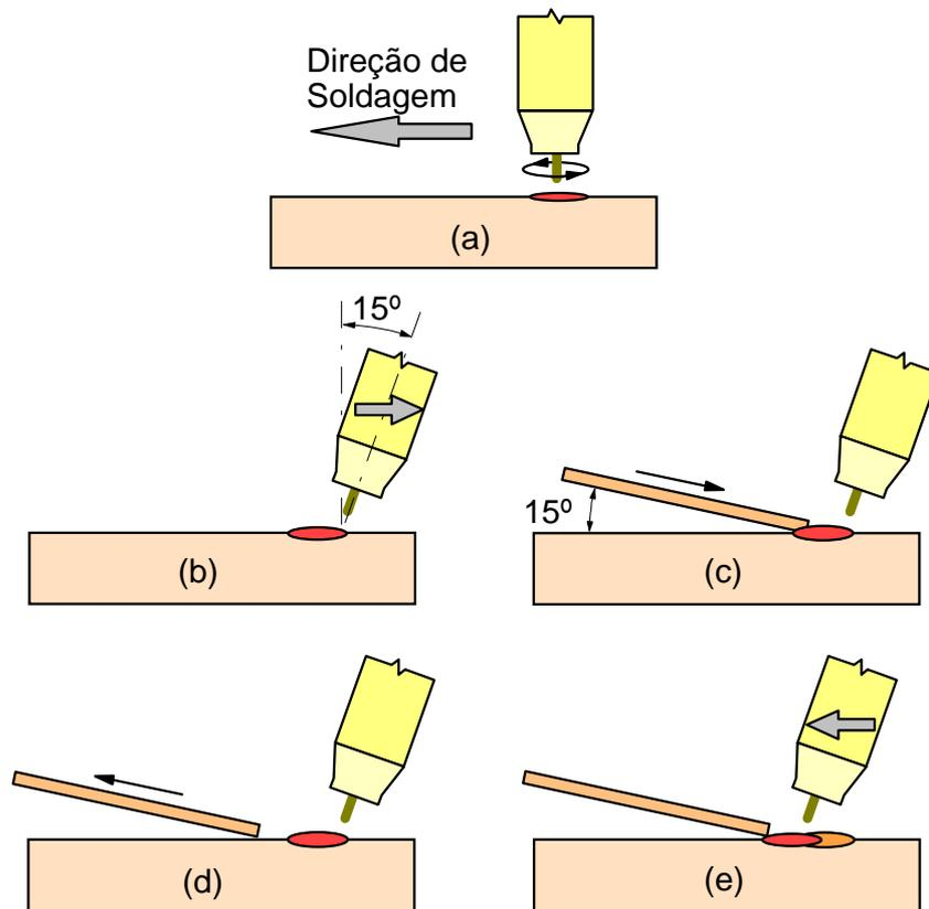
Figura 5 – Técnica para a soldagem GTAW manual com metal de adição<sup>(1)</sup>: (a) Desenvolvimento da poça de fusão, (b) recuo da tocha, (c) adição de material, (d) afastamento da vareta e (e) avanço da tocha conduzindo a poça de fusão.
