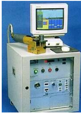
Figura 2: Equipamento de soldagem por ultra-som com controle de qualidade eletrônico.
