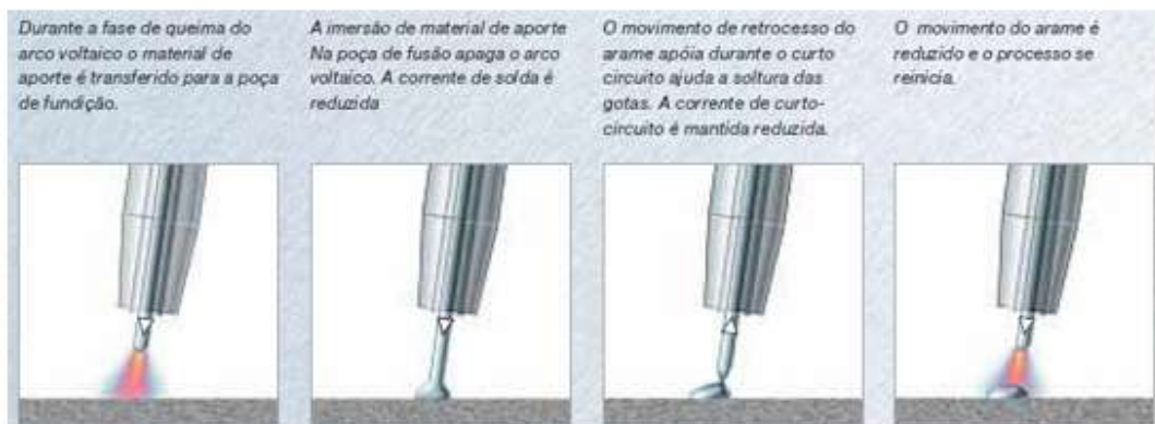
Diagrama esquemático do processo CMT , retirado de [15]
