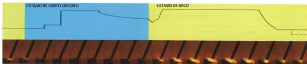
Forma de onda pelo processo FastROOT. Adaptado de [15]
