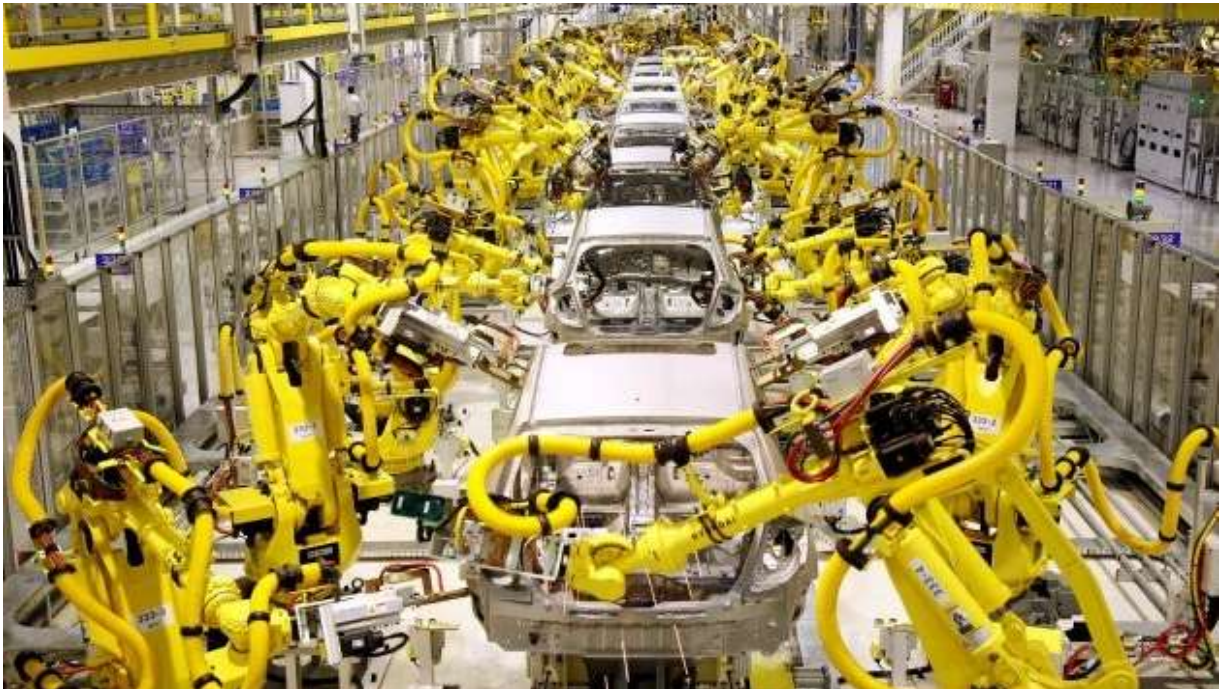
Figura 5-Foto de uma Célula de soldagem de automóveis dotada de inteligência artificial
