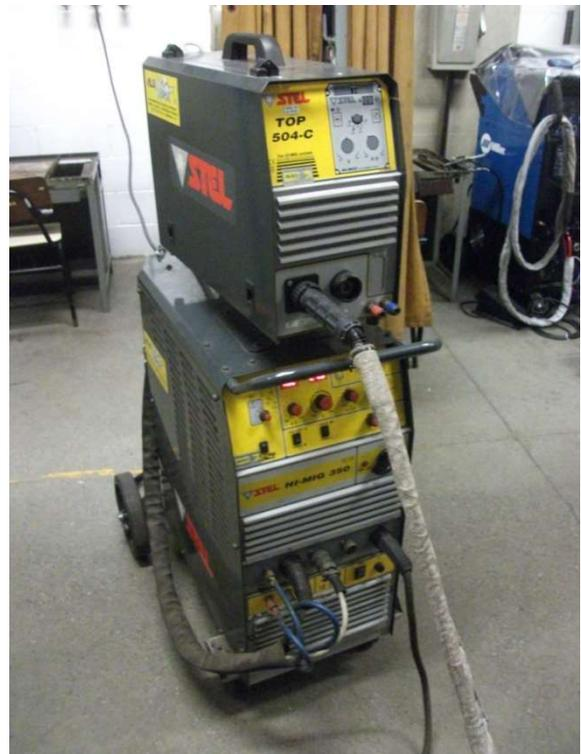
**Figura 5. Equipamento de soldagem GMAW**
