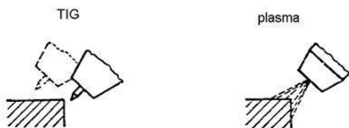
Localização do início da solda
