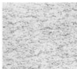
Ti - Puro 99% Laminado (Grãos de \alpha )
