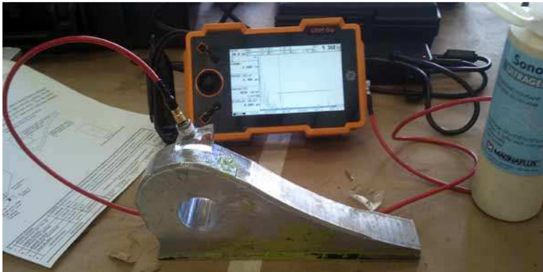
Figura 5 – Ultrassom em um componente na aeronave FONTE: www.aqualified.com
