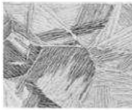
Ti 5%Al 2%Sn Recozido (Grãos de \alpha Agulha)
