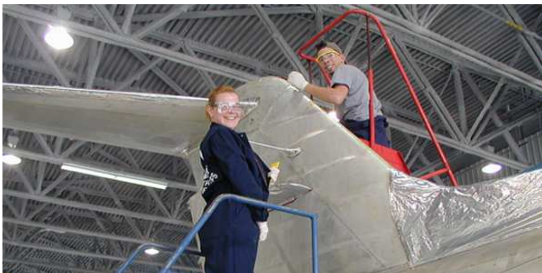
Figura 4 – Ensaio de Corrente Parasita na cauda de uma aeronave FONTE: www.aqualified.com
