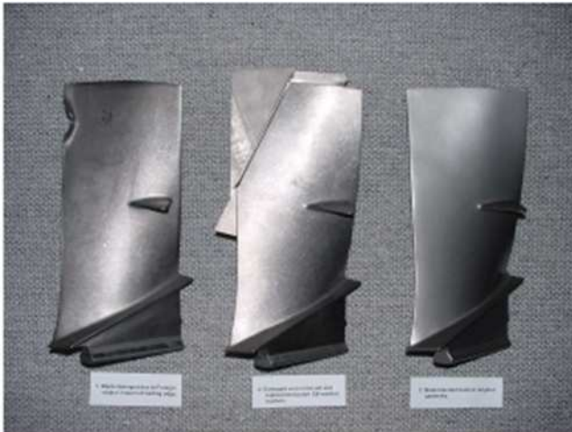
Figura 19 – pás de turbinas de titanio recuperadas por solda na industria militar Fonte: Artigo Electron Beam Weld Repair and Qualification of Titanium Fan Bladesfor Military Gas Turbine Engines
