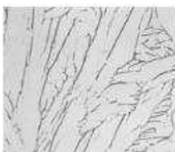
Ti 5%Al 2%Sn Recozido (Grãos de \alpha Plaquetas)
