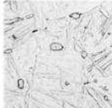
Ti - 0,14%C Recozido (Grãos de \alpha acicular e TiC)
