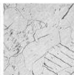
Ti Puro 99% Laminado + Recozido (Grãos de \alpha + maclas)
