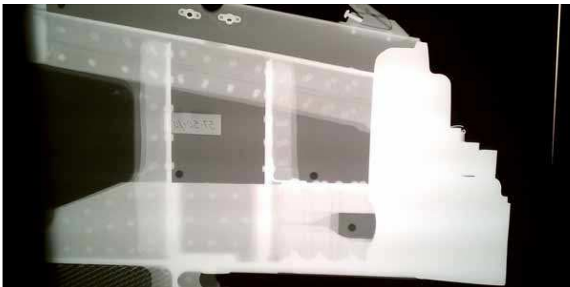
Figura 6 – Radiografia no interior da turbina FONTE: www.aqualified.com
