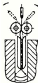
Soldagem com eletrodo pré-deformado
