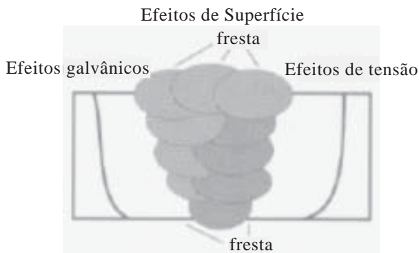
Figura 6 Diferentes tipos de efeitos presentes em juntas soldadas, que as tornam locais preferenciais de processos corrosivos.
