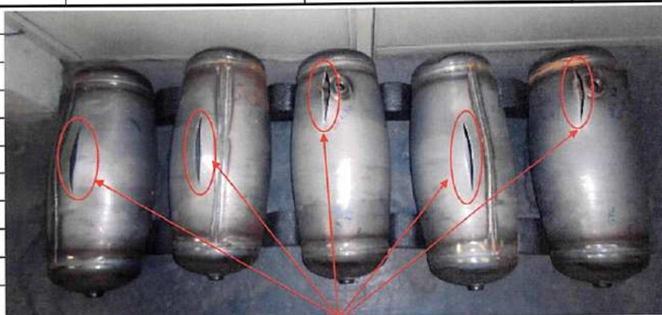
Ruptura não originada na solda.
