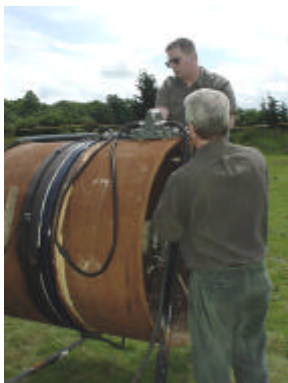
Técnica de radiografia digital em uma solda de tubulação. Na foto do meio, a placa digitalizadora da imagem, gira ao redor da solda, por um guia fixado no tubo.
