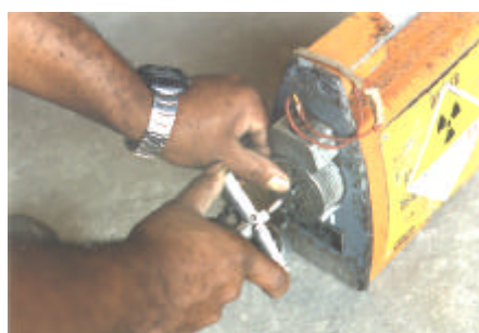
Aparelho para gamagrafia industrial, projetado para operação com capacidade máxima de 100 Ci de Ir-192. O transito interno da fonte no interior da blindagem é feita no canal em forma de "S "
