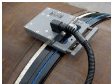
Técnica de radiografia digital em uma solda de tubulação. Na foto do meio, a placa digitalizadora da imagem, gira ao redor da solda, por um guia fixado no tubo.
