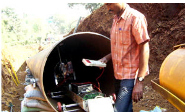
Crawler sendo testado antes de operar dentro da tubulação Foto extraída do website: http://www.sievert.in/Weprovide/crawler.html
