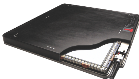
Esquema do detetor para captura da imagem digital no sistema direto.
