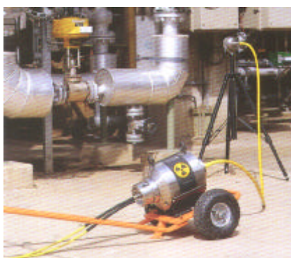
Esquema do Equipamento para Gamagrafia Industrial
