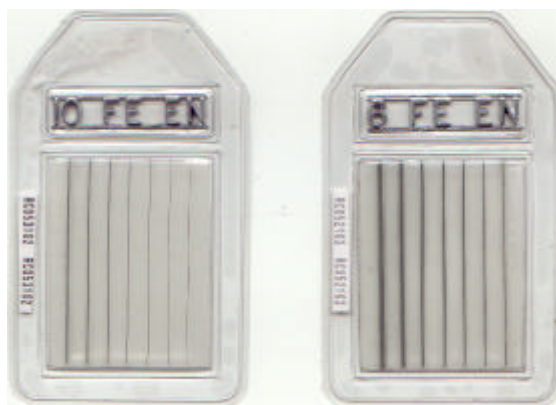
IQI conforme a norma EN-462 Parte 1 (antiga DIN 54109 Part 1)
