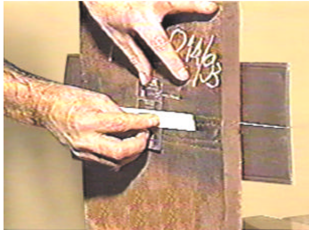
Preparação da exposição radiográfica, fixação do IQI tipo fios sobre a solda a ser inspecionada
