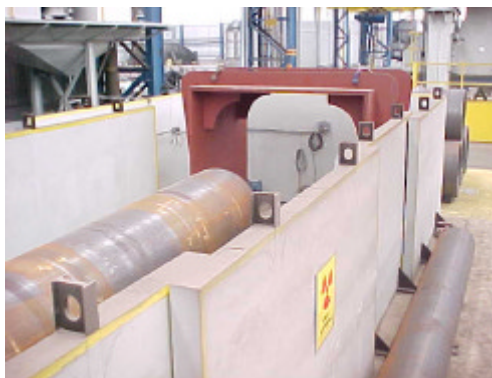
Foto de uma instalação aberta para radiografia de tubos de aço com espessuras de 20 até 50 mm, usando de Raios X e Ir-192.
