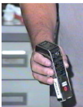
Monitor sonoro e dosímetro digital de leitura direta, opera com detector Geiger Muller
