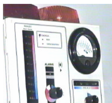
Medidor e Monitor de área sonoro e luminoso, opera com detector Geiger Muller
