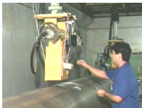
Inspeção radiográfica de soldas em tubos
