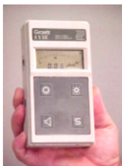
Detector Geiger Muller digital, atua numa faixa de energia de 40 keV até 3 MeV com precisão de \pm 20\% , possui escalas automáticas de 1 \mu\text{Sv/h} até 9,99 mSv/h , com peso de 500 gramas
