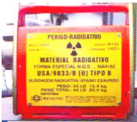
Placa de Identificação do Irradiador
