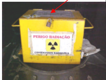
Caixa metálica que contém o irradiador
