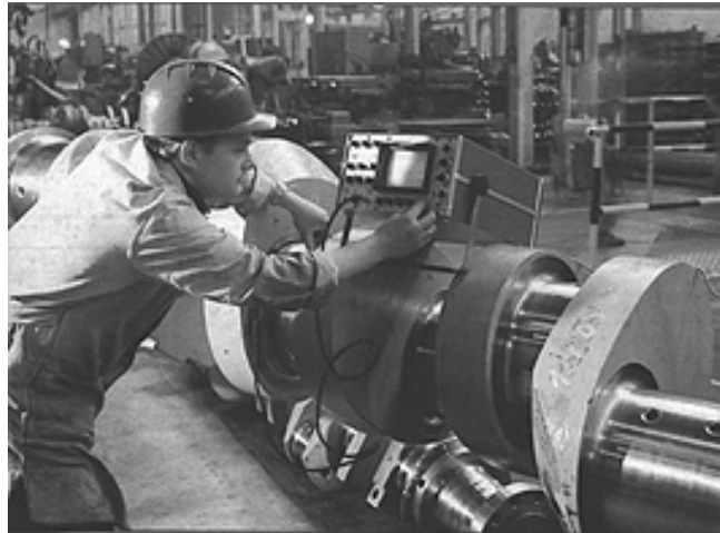
Inspeção por Ultra-Som em virabrequim
