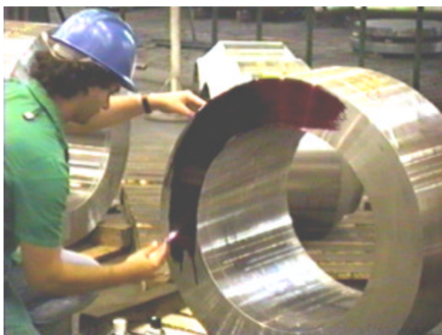
Aplicação do penetrante com pincel
