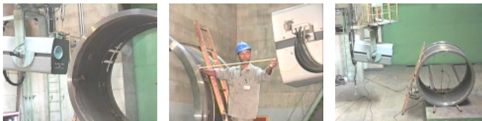
Fotos de um acelerador linear LINAC - Mitsubishi, usado para radiografia industrial de peças com espessura de 20 a 300 mm de aço.
