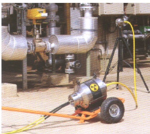
Aparelho para Gamagrafia Sauerwein, usando Fonte Radioativa de Cobalto 60 com atividade máxima de 30 Curies , pesando 120 kg , projetado com tipo de canal reto.
