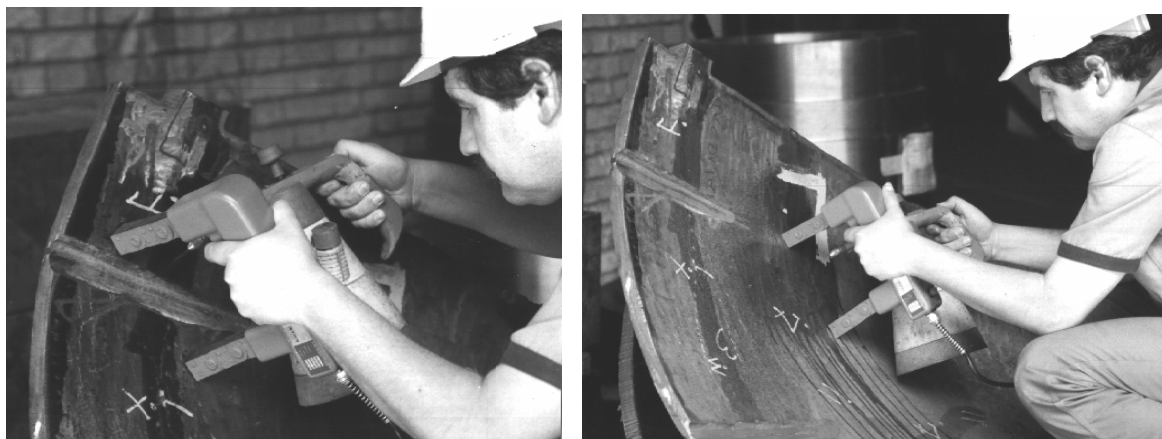
Inspeção por Partículas Magnéticas pela Técnica do Yoke, de uma abertura de reparo preparada para soldagem, em uma Pá tipo “Francis” fundida em aço carbono, para usina hidroelétrica.
