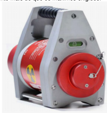
Aparelho para gamagrafia industrial, projetado para operação com capacidade máxima de 120 Ci de Ir-192 ou Se-75.
