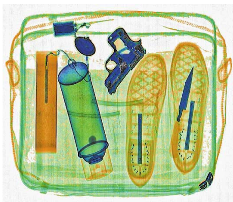
Imagem da radioscopia tradicional com Raios X de 140 kV, usando detector no estado sólido e sistema digital para inspeção de bagagens com resolução de 40 AWG
