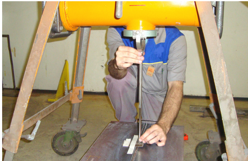
Técnico preparando a inspeção radiográfica de uma junta soldada, utilizando um aparelho de Raios X.
