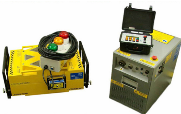
Acelerador portátil betatron industrial, para radiografias de peças com espessuras acima de 100 mm de aço até 300 mm. Projetado para produzir um feixe de radiação de até 7,5 Mev, com ponto focal bastante reduzido de 2 mm. Produz filmes com alta qualidade, mesmo em altas espessuras.
