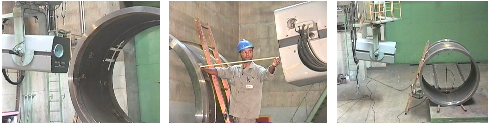
Fotos de um acelerador linear LINAC - Mitsubishi, usado para radiografia industrial de peças com espessura de 20 a 300 mm de aço.
