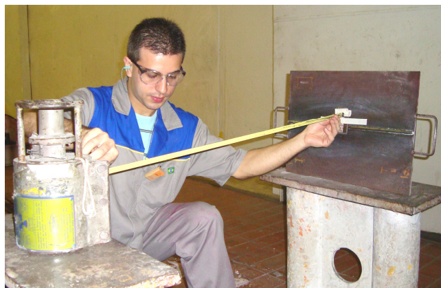
Operador de gamagrafia preparando a exposição de uma junta soldada, usando um irradiador de Ir-192
