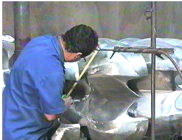
Operador preparando uma radiografia de uma peça fundida – Rotor Pelton
