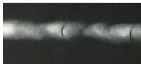
Marcas devido risco profundo na tela ou pressão
