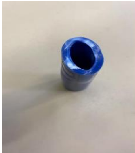
Figura 22 - Tubo PP após o teste (não houve fraturas visuais) teste de ductilidade aprovado
