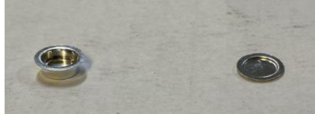
cadinho e tampa com fechamento hermético utilizada para realização do teste.
