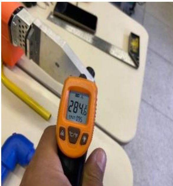
Aferindo temperatura (conforme DVS-2207)
