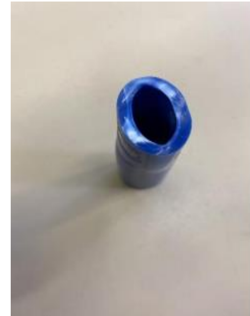
Tubo PP após o teste (não houve fraturas visuais); teste de ductilidade aprovado
