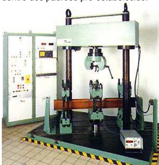
Figura 6 - Teste de fadiga segundo ETC 2000
