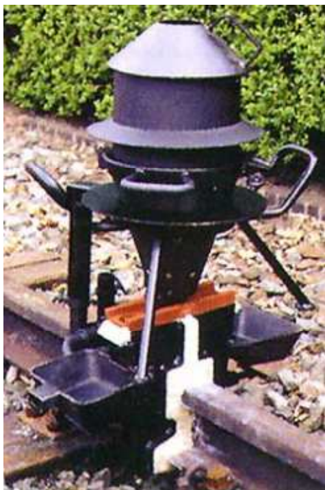
Figura 4 - Sistema cadinho segundo a ETG 2000
