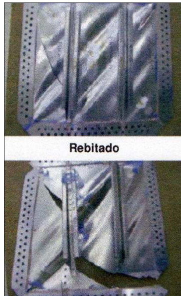
Fig. 14 – Falha em painéis unidos por FSW e por rebites , sujeitos aos mesmos esforços – Khaled.
