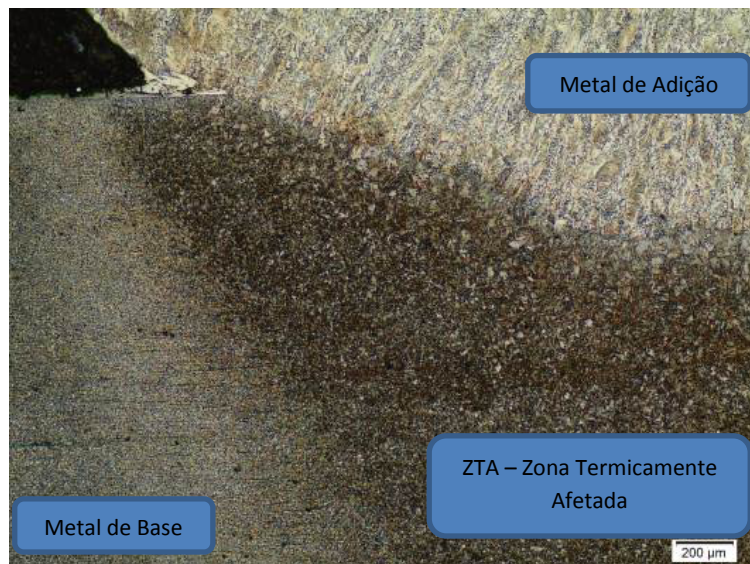
Figura 4: Região soldada (metal de adição, metal base e ZTA)
