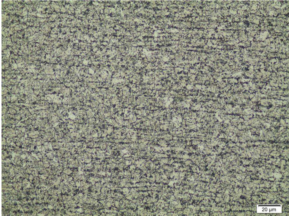
Figura 6: Zona Termicamente Afetada (estrutura ferrítica + perlítica)
