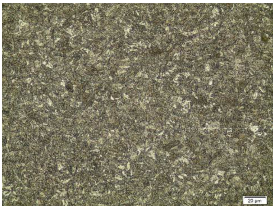
Figura 5: Metal base (estrutura martensita com traços bainita) após soldagem
