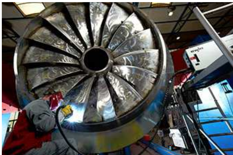
Fig. 4: Rotor para turbina Francis de 25 toneladas – transições de junta sem entalhes são exigidas em todos os casos
