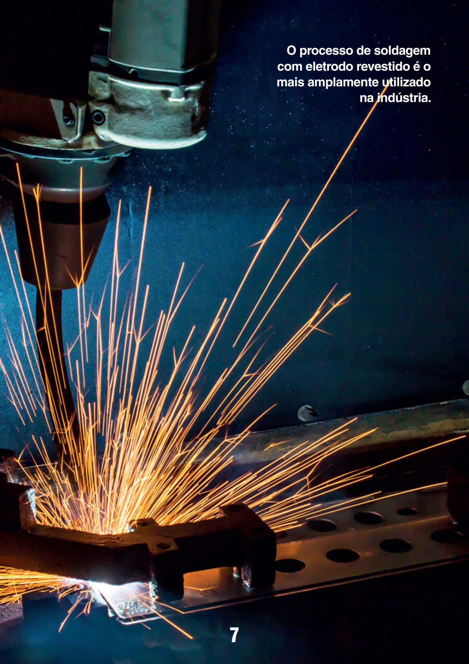
O processo de soldagem com eletrodo revestido é o mais amplamente utilizado na indústria.
